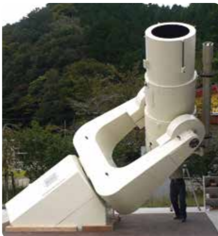
●60cm リッチー・クレチアン式反射赤道儀 京都大学・大宇陀観測所にあった望遠鏡です。建物全体がスライドして空が見えるようになるので、観望会ではこの望遠鏡を使つての観望・観測が行えます。
